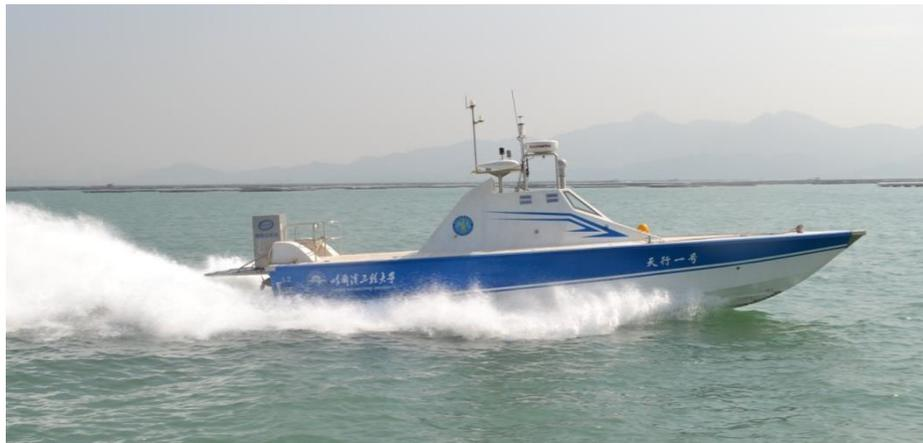
图 4. “天行一号”远程快速无人艇工程样机
